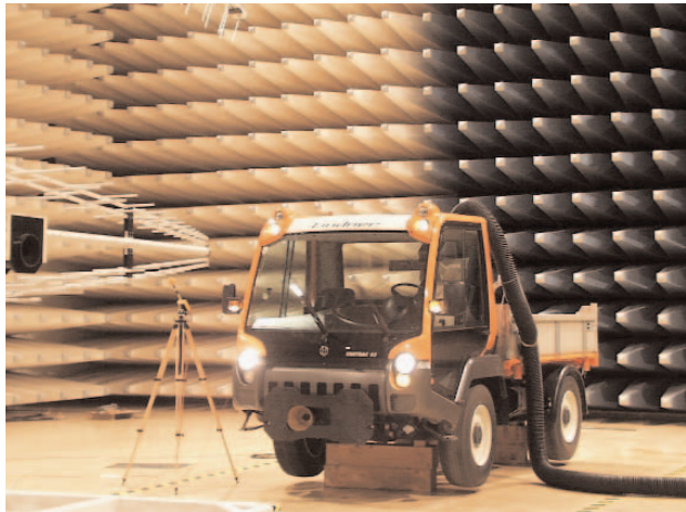
Unitrac 102 im elektro-magnetischen Verträglichkeitstest.
