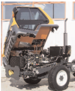
Die kippbare Kabine des neuen Unitrac erleichtert die Wartungsarbeiten.
