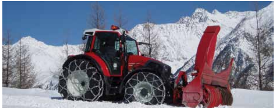
Geotrac 124 mit rumpfführter Fronthydraulik
