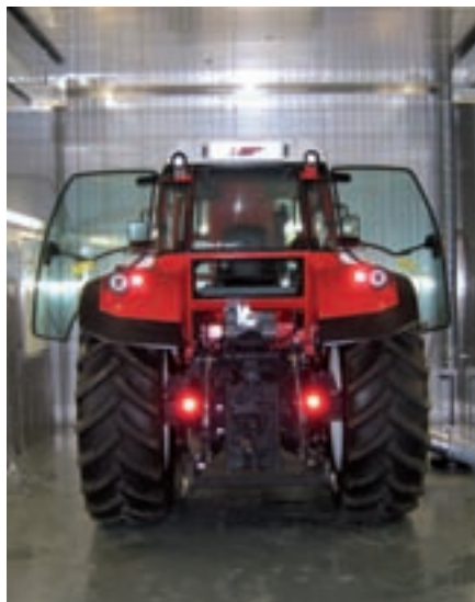
Geotrac 124 in der Klimakammer
