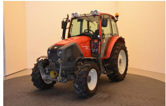
2 Leitungen nach vorne; 6 Kipperleitungen + Rücklauf; Arbeitsscheinwerfer vorne und hinten; FH+FZW inkl. EFH; Aussenbreite 1m88cm; Spur 1m50cm;
