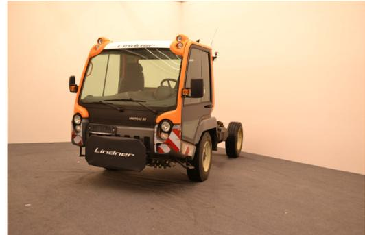
20/20 Splittgetriebe, 50 km/h, Verdrehdämpfung, Kommunalfarbe RAL2011, Klima, Luftsitz, 3-Punktgurt, Rundumleuchte, 2 AS hinten am Dach, Frontzapfwelle, Anhängervorrichtung Automatik 10.000 kg, Kommunalbereifung 285/70-R19,5 Dunlop, Steuergeräteblock vorne; des+dw plus 4 Leitungen + 1 RL, Anbaukonsole EURO 3, Rückwärtsgang m. Signalakustik abschaltbar, Radio, 4-Radlenkung m. Hinterachsverstellung, Weitwinkel li + re und Rampenspiegel rechts,
