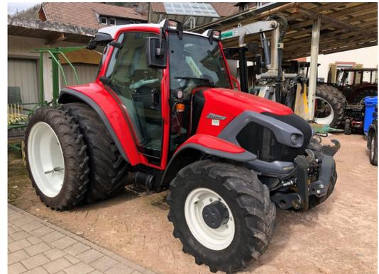
Fronthydraulik mit EFH; Selbstsperrdiff. vorne; Motorvorwärmgerät; inkl. Zwillingbereifung 230/95-R36
