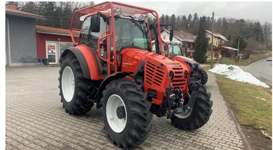
Z58, Bereifung 18,4R34 Nokia Forest FS u. 14,9R24 Nokia Forest, Kabinenfederung mechanisch, Radio, 2 AS vorne zusätzl, 2 AS hinten li+re, Lindner Fronthydraulik, Hub und Druck zu FH, 2 Leitungen nach vorne, Druckluft 2 Leiter, Anhängerbremsventil, 3x dws inkl EH, Steckdose für Stationärbetrieb inkl. Handgas am Kotflügel hinten links, 6 Kipperleitungen+RL, Forstrahmen
