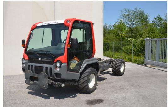
Differentialsperre vorne, 4 Radlenkung, 2 Arbeitsscheinwerfer hinten am Dach montiert, Sicherheitssperre, Druckluftbremsanlage, Frontzapfwelle, Anbauplatte EURO 3, Steuergeräteblock: Ölmotor, POWERLINK, 2x ews, 1x dw, Joystickbedienung,
