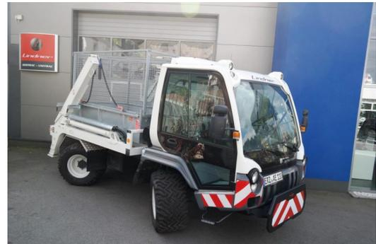
Vorfühmaschine mit JOTHA Absetzkippaufbau, teleskopierbar, 1 Container mit Gitteraufsatz und 1 Schüttgutcontainer (verzinkt) Kommunalanbauplatte, 4-Rad Lenkung,
