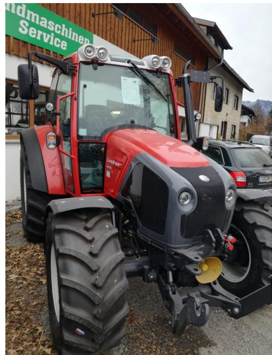
2 Leitungen vorne 2 Arbeitsscheinwerfer H4 vorne zusätzlich Ausziehbare Seitenspiegel EFH Fronthubwerksentlastung Elektro-Hydraulische Frontzapfwellenkupplung Höhen und Neigungsverstellung Lenkrad 4 Rad Bremse 2 Mikroschalter für 3. und 4. Funktion 6 Kipperleitungen + 1 Rücklauf
