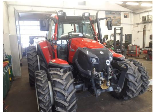
mit Zwillingsräder vorne und hinten, Fronthydraulik mit Hubentlastung, LED Rundumleuchte links, Radio, elektro. Hydr. Zapfwellenschaltung, Radio, " LED Scheinwerfer vorne, 7 polige Steckdose vorne,, Außentaster am Rücklichtgehäuse, 8 Kipperleitungen + 1 Rücklauf
