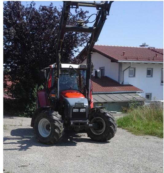
Hauer Frontlader POM C50, Euro-Ausführung mit TopBlock (3. Steuerkreis inkl. 1-Hebelbed. und 2x Microschalteranschlüsse)
