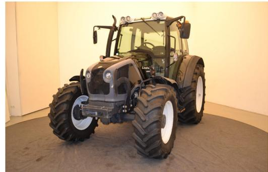
Hauer Frontladerkonsole Top Block mit 4 Leitungen; 2 Arbeitsscheinwerfer hinten; 4 Kipperleitungen + Rücklauf;
