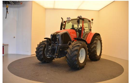
Verstellfelgen vorne und hinten, Planetenlenkachse mit Federung und Sperre, LED-Rundumleuchte links höhenverstellbar, Anhängeschlitten mit Automatik und Piton-Fix mit Zugpendel, zwei Leitungen vorne.
