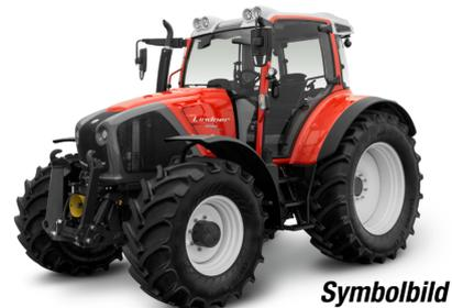
2 Arbeitsscheinwerfer vorne + 2 Arbeitsscheinwerfer hinten, Anhängerbremsventil, 8 Kipperleitungen + 1 Rücklauf , Frontladerkonsole TOP BLOCK + 4 Leitungen
