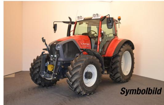
Kabinenfederung pneumatisch, 2 Arbeitsscheinwerfer vorne, 2 Arbeitsscheinwerfer hinten, EFH, 4 Leitungen nach vorne, Multicontroller 9 Taster
