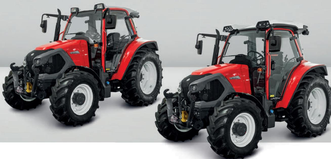
**Im Frühjahr 2021 feiern zwei stufenlose Lintracs ihre Premiere: der Lintrac 80 und der Lintrac 100. Die beiden Traktoren lösen den Lintrac 90 ab. Für einen sauberen und drehmomentstarken Antrieb sorgen die Perkins-Syncro-Motoren der Stufe 5.**
