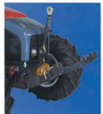
den Drehpunkt der Fronthydraulik näher zur Vorderachse setzen, was sich beim Einsatz eines Frontmäherwerks im Steilgelände positiv auswirkt.
