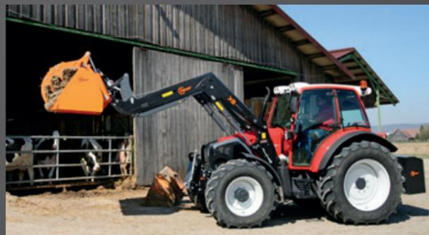
Durch die X-Kinematik wird beim Einziehen des Arbeitsgerätes die größtmögliche Kraft des Zylinders genutzt und beim Auskippen eine schnellere Bewegung erzielt.
