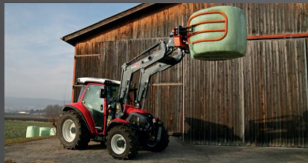
Exakte mechanische Parallelführung mit idealen Einzug- und Auskippwinkeln der Arbeitsgeräte
