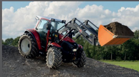
Leicht in der Ausführung – stark in der Leistung: Lindner POM-L Frontlader powered by Hauer sind mit einer mechanischen Parallelführung ausgestattet.
