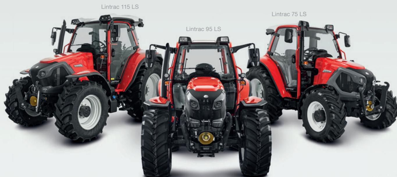
La série Lintrac LS se compose actuellement de trois modèles de 76 à 112 ch. Ces tracteurs se caractérisent de par le grand confort de leur cabine panoramique, la suspension de la cabine, la compensation des oscillations, le relevage avant et la remarquable puissance hydraulique avec gestion séparée des huiles. Les nouveaux Lintrac LS sont équipés du nouveau moteur Perkins-Syncro qui répond à la norme antipollution stage 5.
